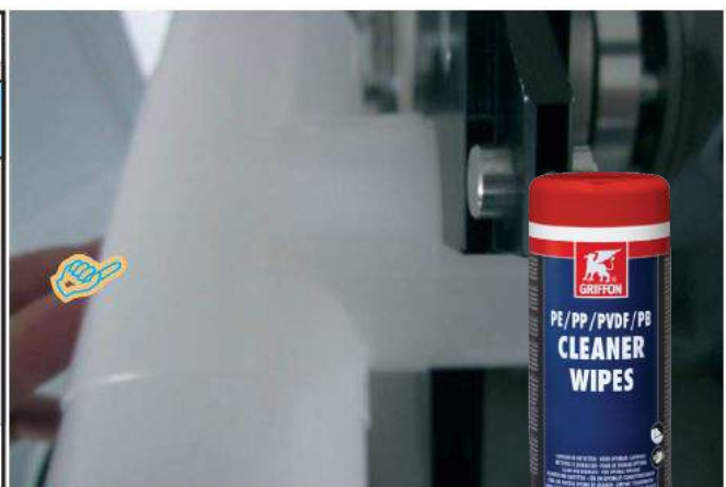
6 6. Afsprit med DREIN spritservietter og spænd den "korte" komponent op - Her: T-stykke.
