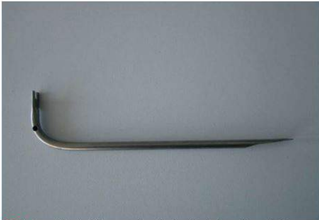
37. Specialværktøj til at fjerne ballon på indersiden af den nye svejsning.
