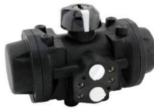
Pneumatisk aktuator fås som dobbelt-virkende (DA), normalt åben (NO) eller normalt lukket (NC)
